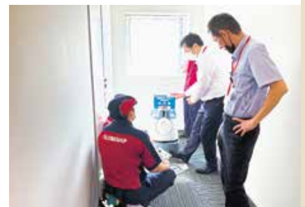
清掃ロボットに走行ルートや作業内容を教えこむ、ティーチング作業
